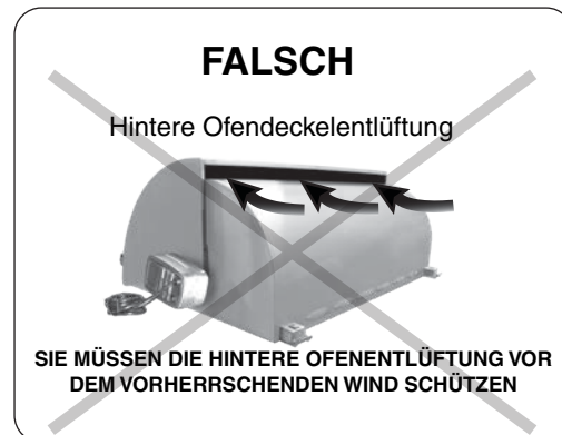
Abb. 11-4 Richtung des Luftstroms - FALSCH
